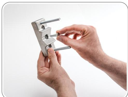
۴- نحوه قرار دادن دو عدد پیچ مرکزی درون گیره لوله
