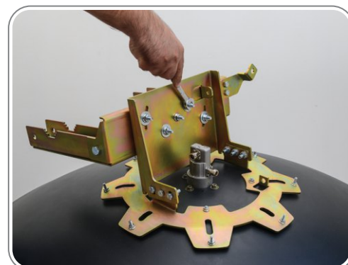
۸- نصب مهارکش اول جهت حرکت عمودی سر آنتن به صورت میلیمتری (Fine Tune)
